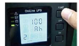
■ Ajuste la base de la capacidad de la batería a través del panel LCD
